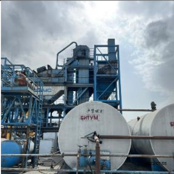
Фото 76. АБЗ на Лот 2. Емкости и резервуары промаркированы
